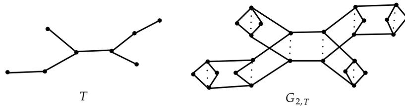
Рис. 6.1: Дерево  $T$  и экстремальный минимальный двусвязный граф  $G_{2,T}$ .
